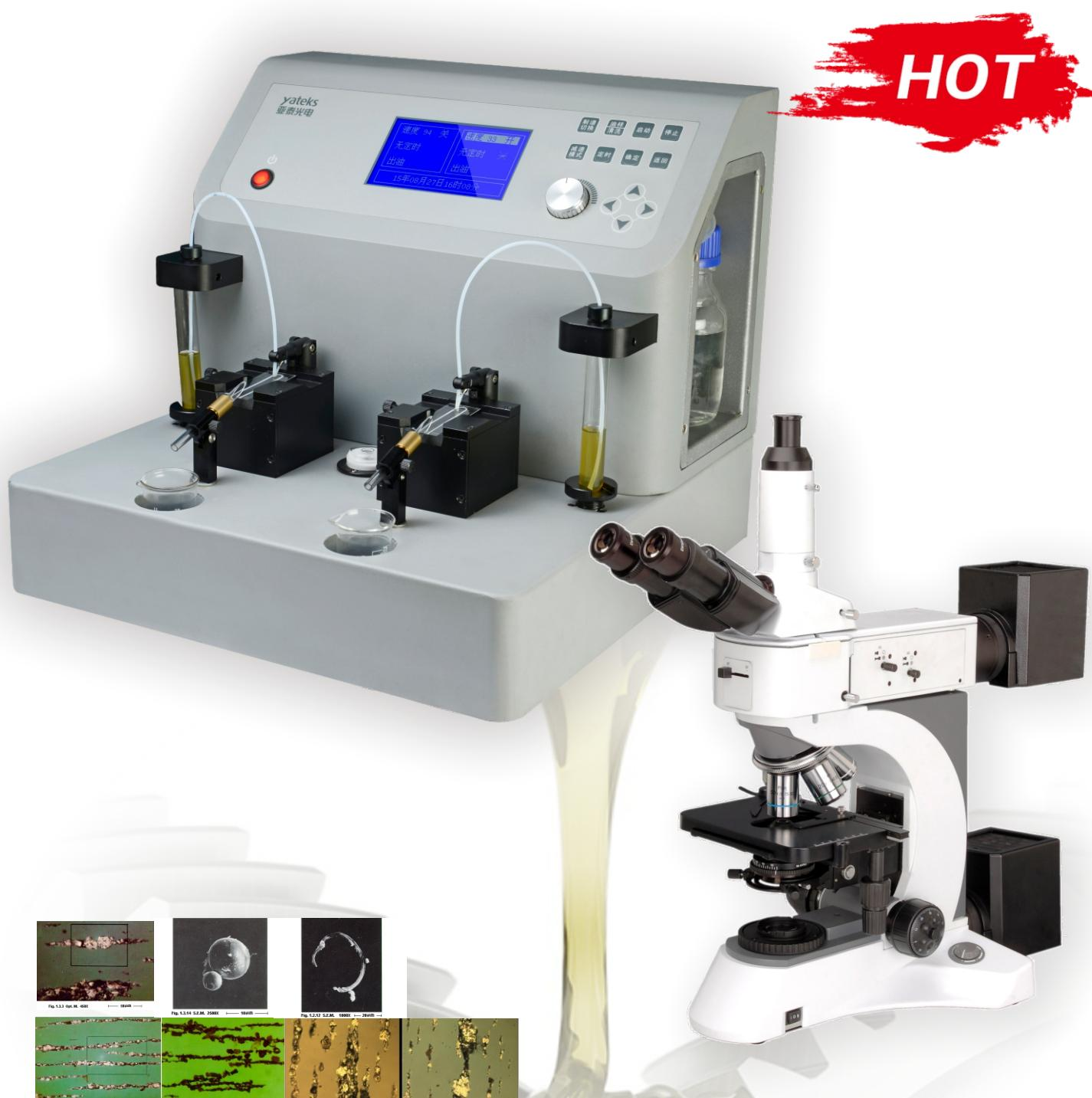
**分析式铁谱系统**包括分析式铁谱仪、铁谱分析显微镜、图谱软件管理系统三部分组成。分析式铁谱仪是利用高梯度强磁场将机器润滑油中的铁磁性及顺磁性磨粒分离出来，并按其粒度大小顺序地沉在玻璃片上制成铁谱片，再利用铁谱分析显微镜对铁谱片上的磨损微粒进行形态、尺寸、成份及数量等方面的观测和分析。配合图谱软件管理系统可建立用户图谱数据库，方便图谱的日常管理和分析。
