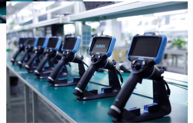
工业内窥镜，亦称内窥镜，是一种多学科通用的工具，其功能是对弯曲管道深处探查，能观察不能直视到的部位，能在密封空腔内观察内部空间结构与状态，能实现远距离观察与操作。
