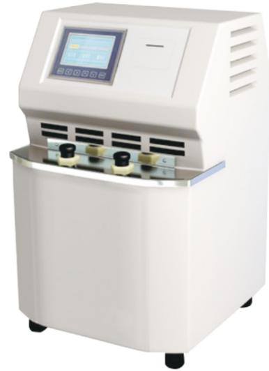
航空煤油、车用柴油、机油凝固点温度的检测，使用特殊的传感器来记录下机油从固态到液态转化的那个温度。具体过程是先对样品机油冷冻到完全固态然后打开传感器系统。柴油浊度的测量方法是基于红外线短波穿透样品的特性来测量的。
