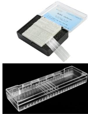
铁谱片，分析式铁谱仪耗材，用于油品定性分析——铁谱分析制谱用。油样经虹吸泵引导流入铁谱片，在高梯度磁场作用下，油品中的铁磁性颗粒会按照规律排布于铁谱片的U型槽内。
