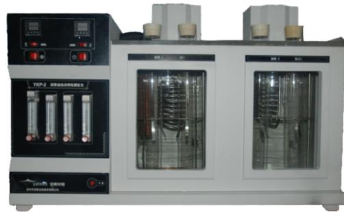
润滑油泡沫特性试验器按照GB/T12579-90、ASTMD892《润滑油泡沫特性测定法》标准测定发动机润滑油、齿轮油、液压油等油品的泡沫特性，用以评定润滑油的泡沫倾向性及泡沫稳定性。
