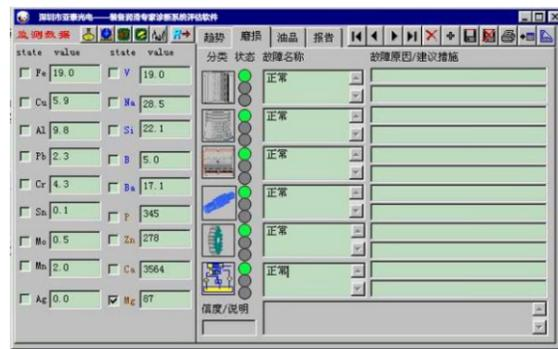
建立装备专家诊断系统评估软件，对在用润滑油的性能变化和油中磨损颗粒的情况跟踪分析，获得机械设备的润滑和磨损颗粒状态的信息，评价新油及在用润滑油的质量和所携带的磨粒这两方面综合评价设备的运行状态。
