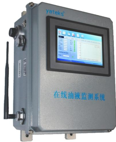
该系统可用于实时监测装备润滑及磨损状态。采用高黏度流体振动传感技术、高分子薄膜电容技术和铁磁磨粒感应技术，可以实时监测油液颗粒污染，水分、粘度、品质以及磨损，提前预知装备的润滑状态，及时更换润滑油。同时跟踪磨损变化，发现摩擦副早期失效，避免事故的进一步恶化。
