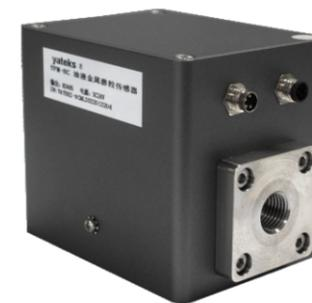
电磁式油液金属磨粒传感器是在线测量油液中金属磨粒的数量、大小（在传感器量程内根据颗粒大小，铁磁性颗粒分十个尺寸带，非铁磁性颗粒分四个尺寸带）和性质（铁磁性和非铁磁性）的传感器。
