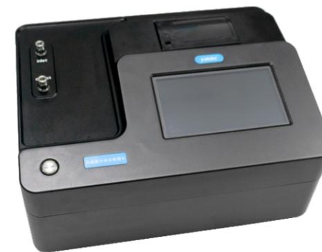
YOT系列油品综合分析仪是一款多功能高精度油品综合分析利器，该设备可快速检测被测油品的洁净度、运动粘度、水分、密度、品质、磨损颗粒等指标。仪器采用高精度嵌入式微处理器作为主控核心，嵌入迷你型操作系统，实现了工作过程自动化，具有测量准确度高、重复性好、性能稳定可靠等特点。
