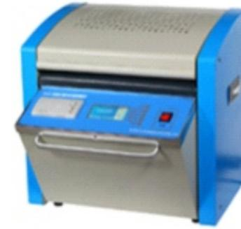
YJS系列自动油介损及体积电阻率测定仪符合GB/T 5654、IEC 60247标准，用于测定在试验温度下呈液态的绝缘材料的介质损耗因数及体积电阻率，包括诸如变压器、电缆及其它电气设备内的绝缘液体。可广泛应用于电力、石油、化工、商检及科研等部门。
