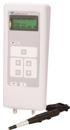
YVZ系列轴承故障检测仪是集冲击脉冲仪、振动测量仪和听诊器于一体的多功能设备故障诊断仪器。可用来检查旋转机械的运行状态，从而探测出机械故障并为有效的预防性检修提供数据。可广泛应用于航空航天、冶金、化工、轻工、船舶制造等领域。
