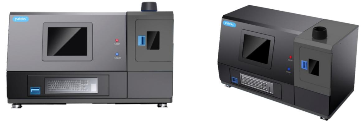
光谱仪可对油样中的微量金属磨粒污染物及其添加剂的元素成分、浓度进行准确测定,从而掌握设备的磨损状态、润滑状态及润滑油的污染状态等信息;通过对历史数据(检测结果及设备维护保养记录)进行统计分析 & 趋势分析,全面掌控设备的磨损趋势及润滑状态的变化趋势;基于这些统计分析结果可以对检测结果设置报警限,为设备潜在故障进行预警,时刻保证设备处于正常工作状态,最大限度提高设备的可靠性。
