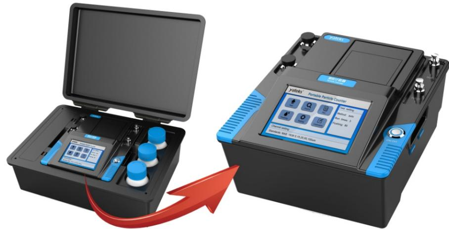
YJS便携式颗粒计数器采用遮光法（又称光阻法）原理研制，用于检测液体中固体颗粒的大小和数量，可广泛应用于航空、航天、电力、石油、化工、交通、港口、冶金、机械、汽车制造等领域中，对液压油、润滑油、变压器油（绝缘油）、汽轮机油（透平油）、齿轮油、发动机油、航空煤油、水基液压油等油液进行固体颗粒污染度检测，对有机液体、聚合物溶液进行不溶性微粒的检测。
