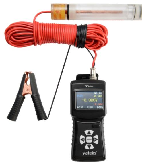
YVE系列电位测量仪可直接反映出设备的阴极保护状态。实践中，钢铁的保护电位常取-0.850V（饱和铜硫酸铜电极），当金属处于比-0.850V更低的电位时，该金属得到了保护。此外，YVE系列电位测量仪还可以测量其它阳极金属材料（如铝、铜等）的保护状态。
