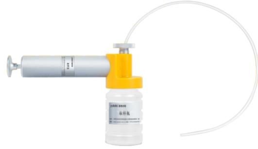
采用负压抽油枪，搭配一次性无污染取样管、取样瓶，有效避免外界杂质污染油样；用于对现场的润滑油等油液取样，带回实验室进行铁谱、光谱、粘度、铁量等指标的分析。
